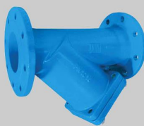
Y Strainers DN 50-300 mm PN 10-40 bar ANSI Class 150 & 300
